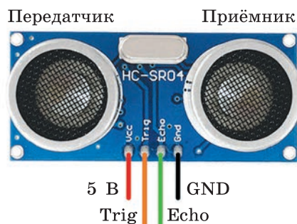
Рис. 90. Датчик расстояния HC-SR04
