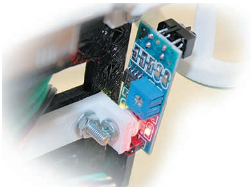
Рис. 65. Работающие светодиоды на датчике линии
